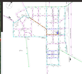
Sistema de Distribución de Agua Potable para 7 Localidades del interior del Chaco.
